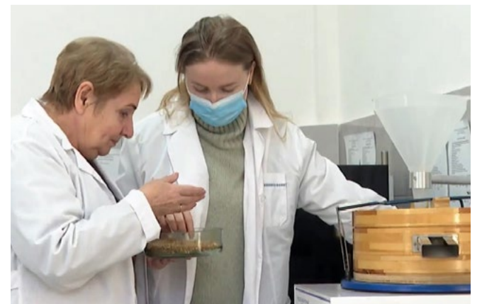
Определение вредителей в зерне с помощью сита
